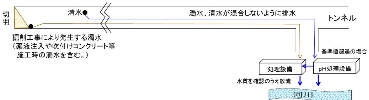
図 4.46 トンネル湧水の清濁分離（イメージ）
