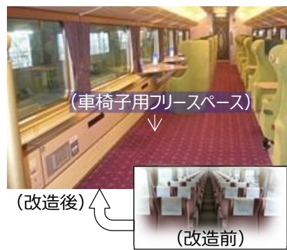
既存車両への車椅子用フリースペースの導入
