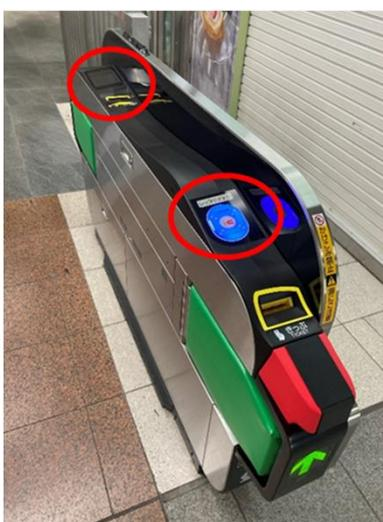
自動改札機の斜め向きタッチ・液晶部分
