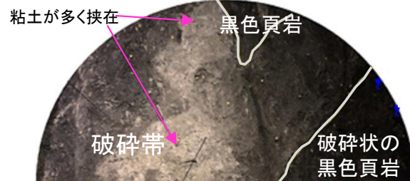
①156km387m 右側は破碎状の黒色頁岩が占めており、左側は破碎帯が所々形成されている状況。
