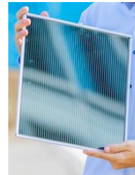
ペロブスカイト太陽電池サブモジュール（モックアップ） 寸法：100 cm × 30 cm（建材一体型太陽電池サイズ）
