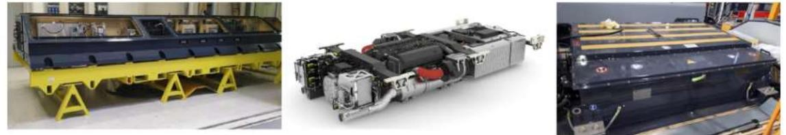
電力変換装置（左）、ディーゼルエンジン発電機（中央）、主回路蓄電池（右）の外観をそれぞれ示す。
