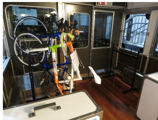
車内搭載スペースへの サイクルラック設置 (JR西日本 LA MALLE DE BOIS)
