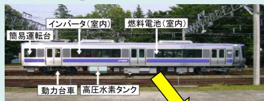
試作車両では、電力変換装置(インバータ)等が客室を占有
