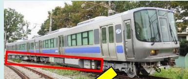
電力変換装置の小型化により、車両床下への搭載を可能とし、客室の空間を確保
