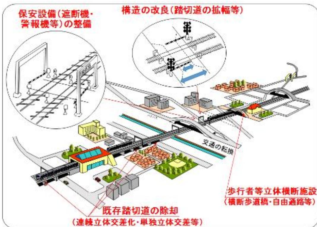
図30: 踏切道の除却・改良のイメージ
