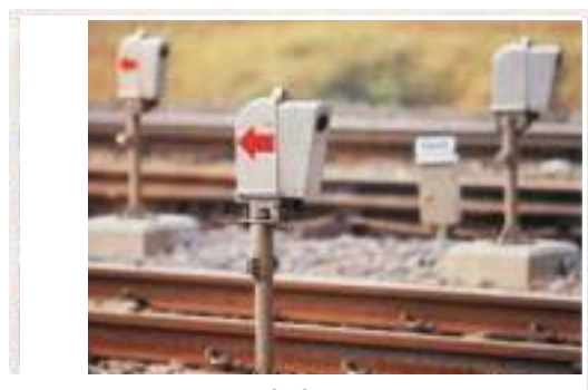
踏切障害物検知装置
