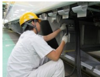
車両製造 （配線配管作業）
