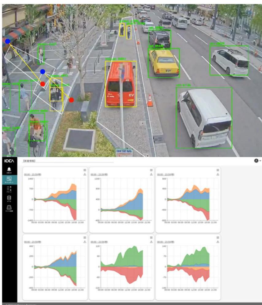
図 3-7 AI カメラによる画像解析と「IDEA(アイデア)」での可視化結果
