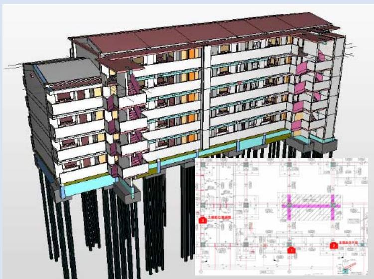
BIM施工図データ、施工管理アプリによる配筋検査資料
