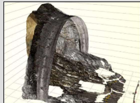
Geo Scan Advanceにて取得した切羽の3Dデータ
