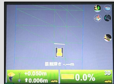
マシンコントロール搭載建機内のモニター画面
