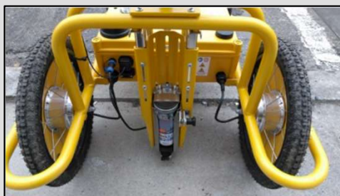
スプレー缶設置状況
