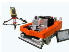
墨出しロボット(3機種)
