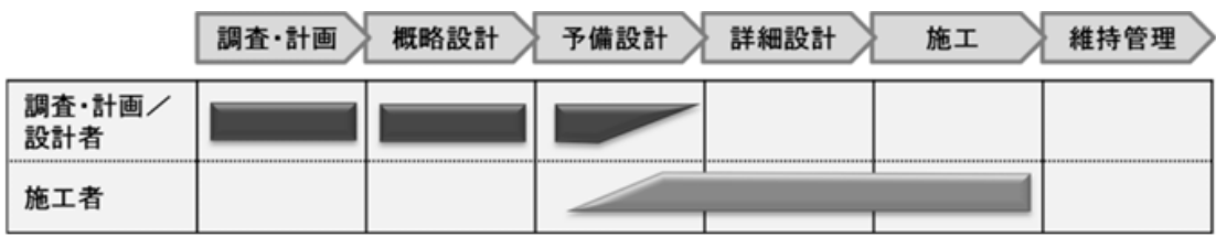
図-3.8 設計・施工一括発注方式の適用段階
