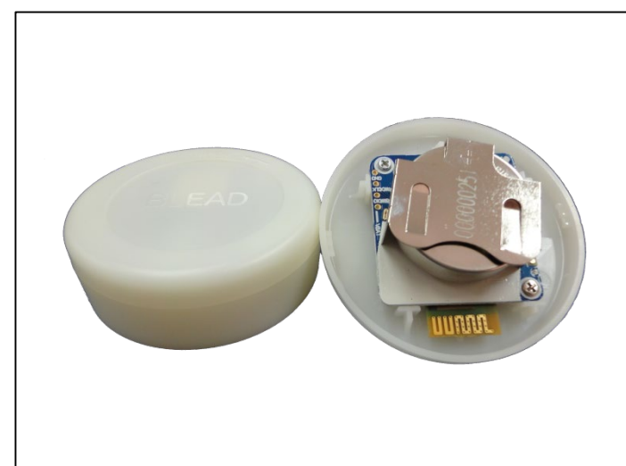
本プロジェクトで設置したビーコン（一例） 大きさ：直径50mm 厚さ17mm 重さ：15.5g(ボタン電池含む)
