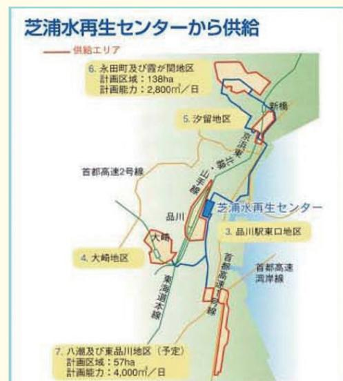
そのような中、平成 22 年度には、永田町及び霞が関地区、八潮及び東品川地区などのオフィスビル内のトイレ用水や道路散水などの需要増に対応するため、国内で初めてセラミックをろ過材に使用した再生水造水設備を芝浦水再生センターに導入し、造水能力の増強を図りました。
