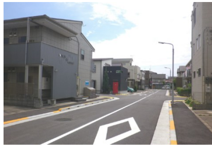
区画道路における無電柱化
