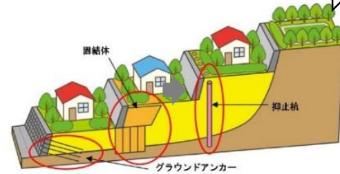
対策工事のイメージ
