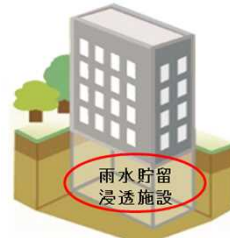
雨水貯留浸透施設
