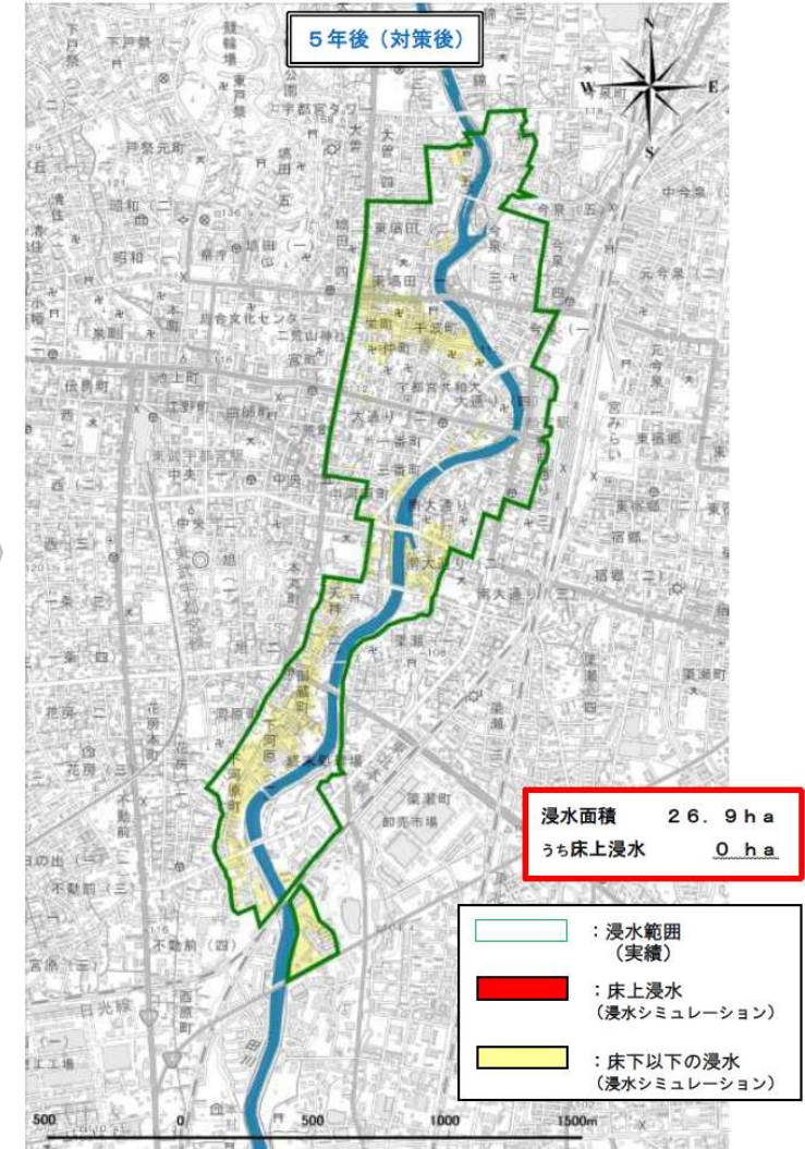
図 5年後(対策後)における田川流域の浸水図(東日本台風の降雨)
