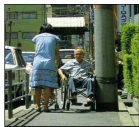
<歩行の支障となる電柱>
