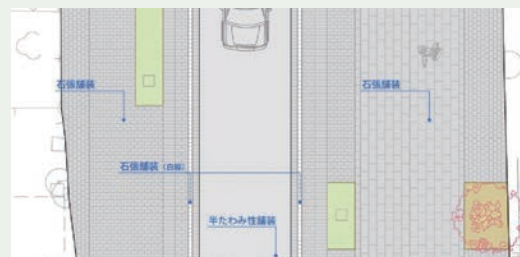
旧山陽道 松崎地区（防府市） 歩道舗装は石張り、車道舗装は半たわみ性を採用
