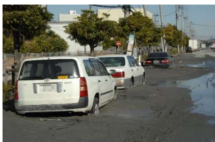
写真-1.2 噴砂による車両の埋没
