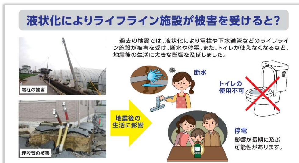
図-4.5.10 過去に発生した液状化被害の事例 (A市)
