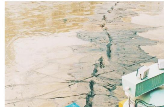
図-2 校庭の噴水・噴砂、亀裂
