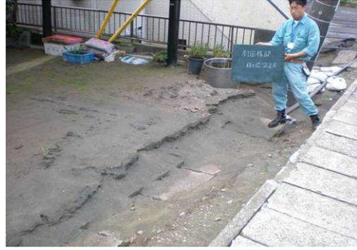
写真3-2 宅地地盤の液状化に伴う大規模な噴砂状況<sup>6)</sup>
