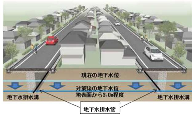
図 1-2 道路と宅地の一体的な液状化対策のイメージ (道路の地下水位低下の効果が宅地内まで波及する)
