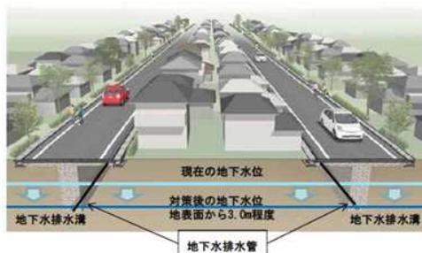
図4-1 地下水位低下工法のイメージ
