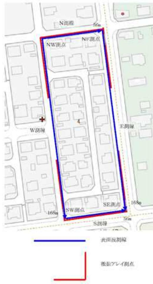
図 4-33 表面波探査測線位置図例
