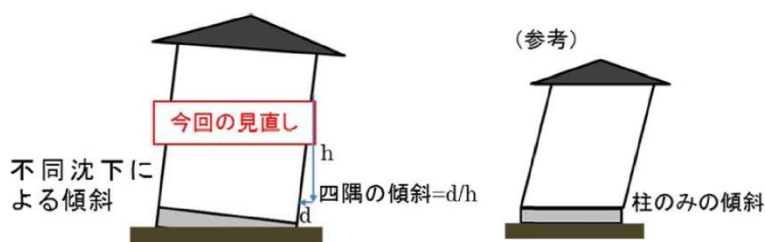
図-1 住宅の傾斜による判定
