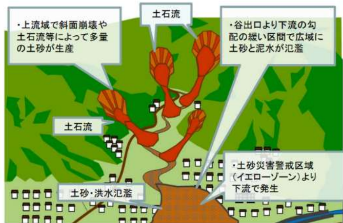
図 5.10 土砂・洪水氾濫のイメージ
