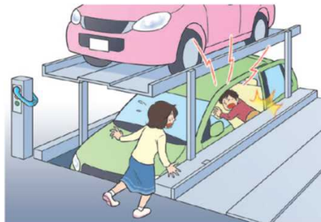
イラスト2 ボタン押し補助器具の使用と装置内立ち入りが容易のために起きた死亡事故例
