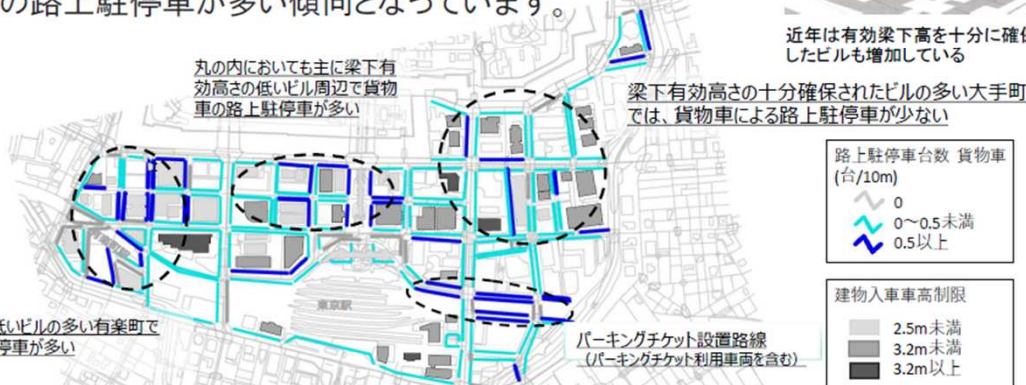
図5-8 建物の入庫車高制限と貨物車の路上駐停車状況
