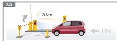
機械式ゲートの設置による不適正利用対策の事例
