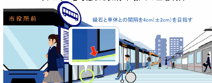
図 バス停での正着システム
