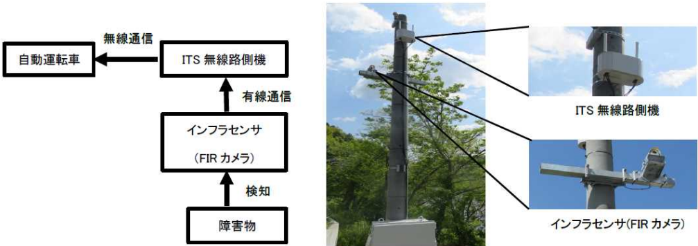
図 4: 地上側インフラセンサのシステム構成および設置の様子
