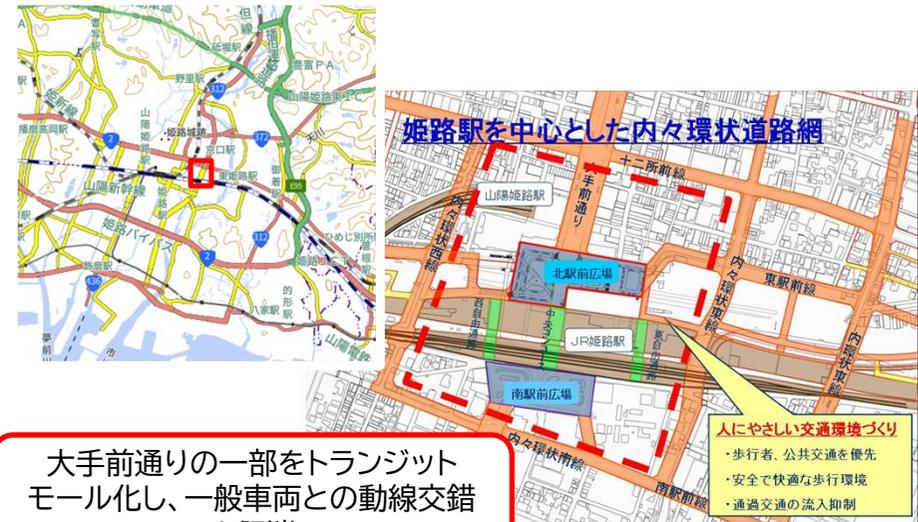
大手前通りの一部をトランジットモール化し、一般車両との動線交錯を解消
