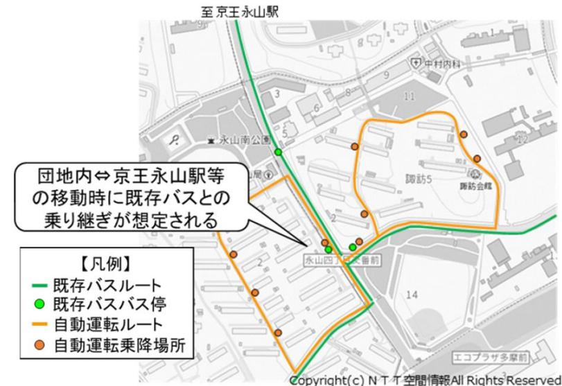
図 団地内の自動運転実証実験ルート例(多摩市)
