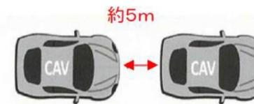
※高速道路を100(km/h)で走行時に、車車間通信技術を用いた場合の試算
