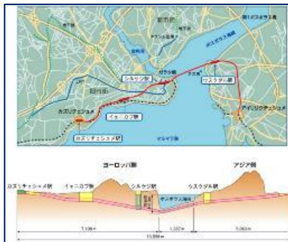
海底鉄道トンネル工事区間 出典：大成建設HP
