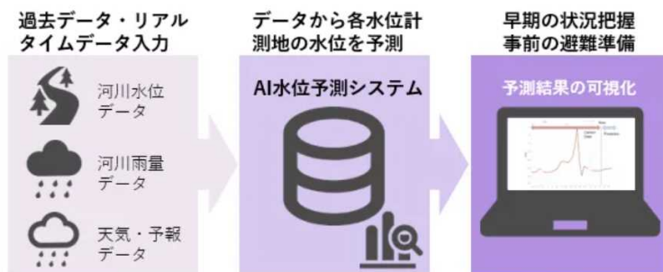
図.AI水位予測システム概要
