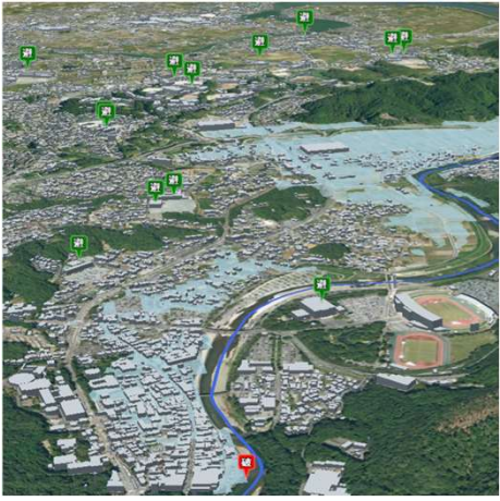
浸水シミュレーション (全景) ・五十鈴川河川氾濫時の浸水状況と避難場所の表示。
