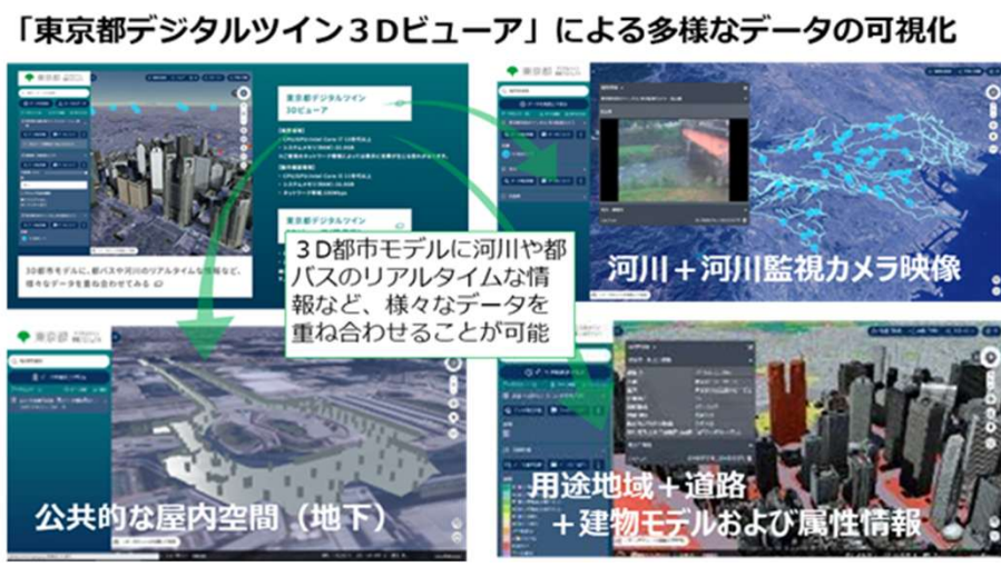
「東京都デジタルツイン3Dビューア」による多様なデータの可視化 3Dビューア上のベースマップとして3D都市モデルを活用し、河川監視カメラ映像や用途地域など、多様なデータを可視化。
