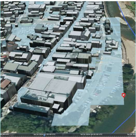
浸水シミュレーション (近景) ・五十鈴川河川氾濫による破堤点BP044の破堤から、約2時間後のおはらい町地区の浸水状況。
