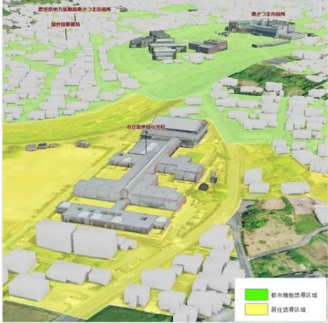
都市計画決定情報の重畳表示 建築物LOD1及びLOD2と立地適正化計画の2区域を重畳表示したイメージ図
