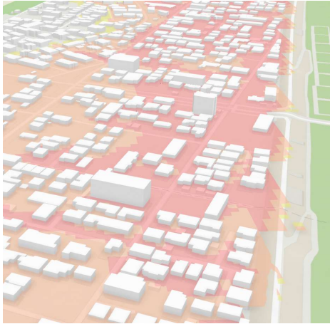
災害リスク情報（洪水浸水想定区域） 災害リスク情報（洪水浸水想定区域）を可視化して、建築物モデルと重畳することで、着目する建築物がどの程度浸水するかが視覚的に把握できる。
