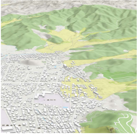
災害リスク情報（土砂災害警戒区域） 災害リスク情報（土砂災害警戒区域）を可視化して、建築物モデルと重畳することで、避難確保計画の作成及び避難訓練の実施等に寄与される。
