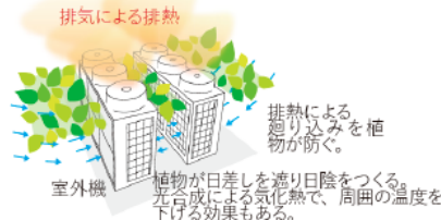
室外機まわりの緑化による排熱ショートサーキットの回避
