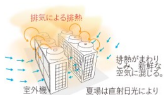
室外機まわりの空気の流れ（排熱のショートサーキット）
