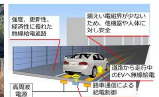
走行中給電施設
