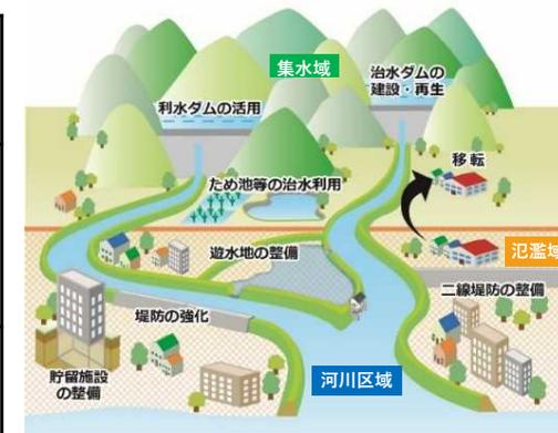
気候変動による水災害リスクの増大に備えるため、「流域治水」の考えに基づき、河川事業と併せて、集水域から氾濫域にわたる流域のあらゆる関係者で水災害対策を推進
