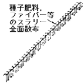
種子散布の例【出典：道路土工 - のり面工・斜面安定工指針】
