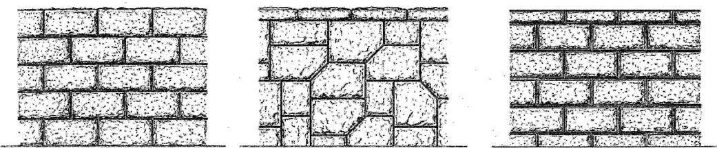
12. 切石積は、切角石を用いた石積で、大きさの異なる大小の切石材を組合せ、面をそろえて積み上げたもののこととする。
