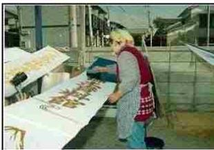
写真 白抜きにしたい部分（文字）に糊置きをした後、刷毛で引き染めをする
