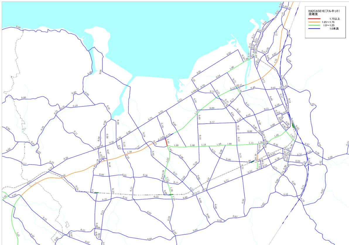
将来 (H42) 交通量推計 (CASE2) 結果 : 混雑度
