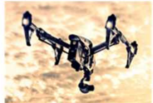
移動型LPWAルーター (ドローン)
