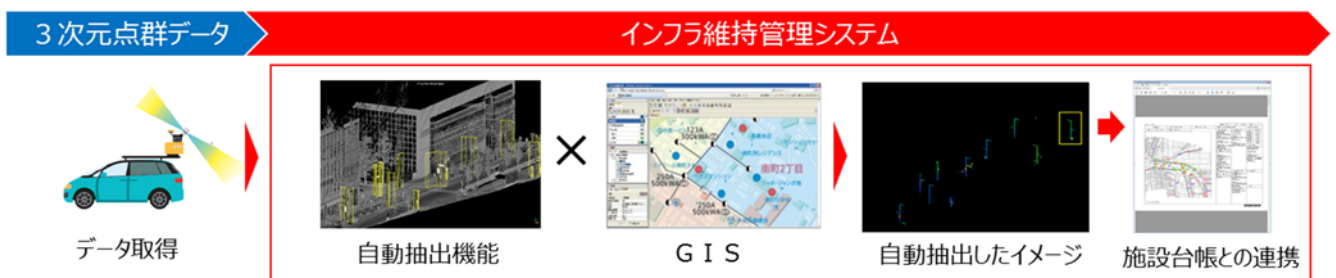
(図5) 3次元点群データを活用したインフラ維持管理システムのイメージ
