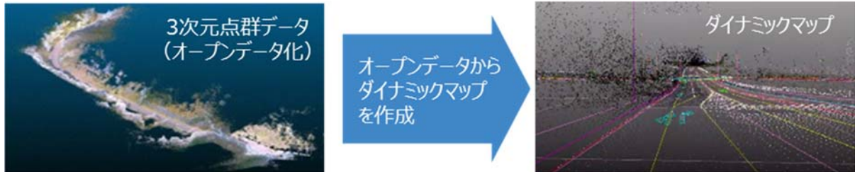
(図6) 3次元点群データからダイナミックマップを作成するイメージ
