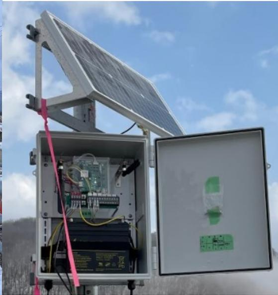
ソーラーパネル（設置傾斜 60 度）
