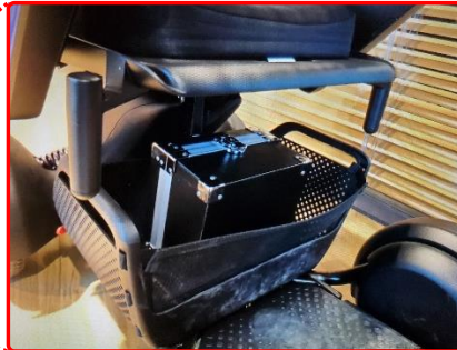
PSMにデジタルキーモジュールを格納したケースを設置
