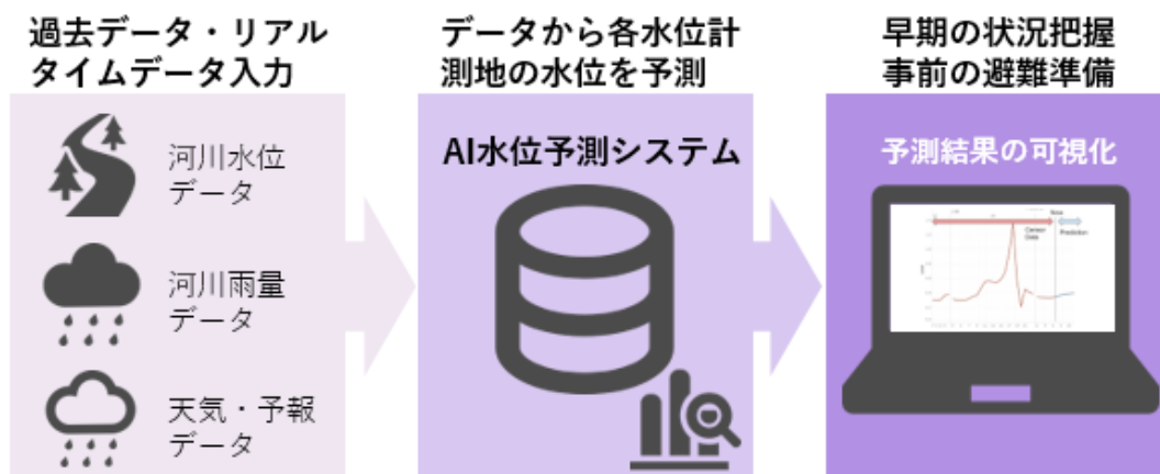
図 4-12：水位予測システム概略図
